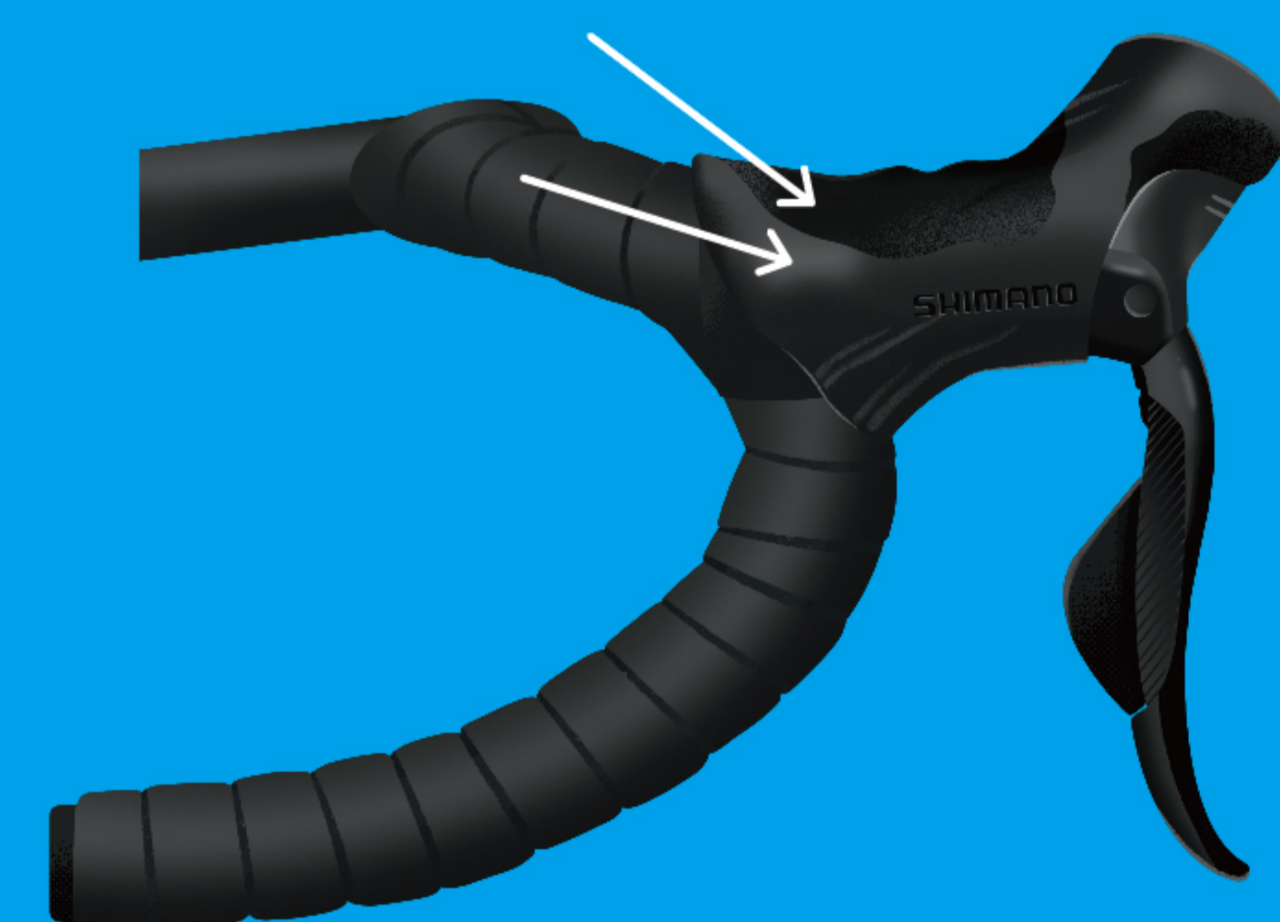
握把套變薄或者材質硬化、表面紋路也磨損或變得可以扭動或移動，就是該更換了。
