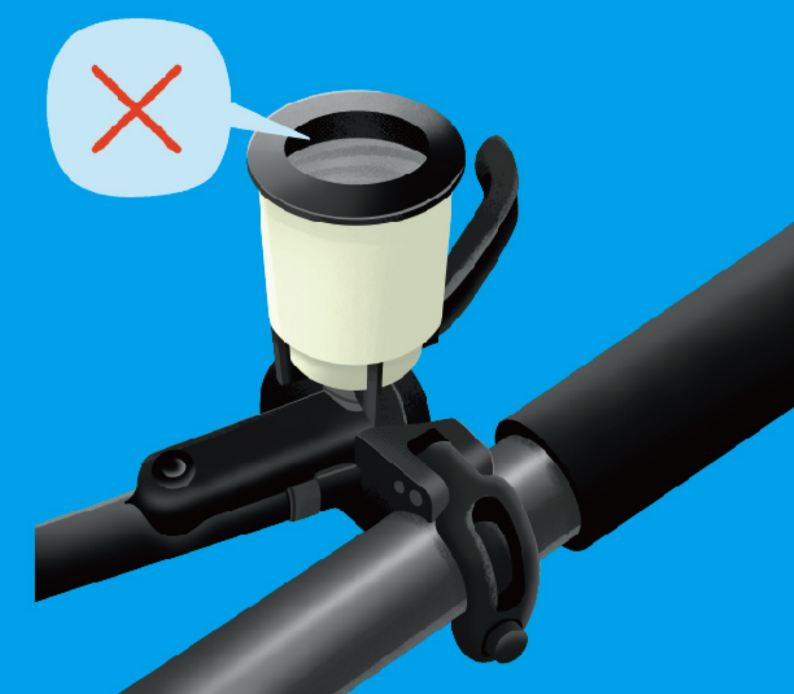
儲油槽的油已混濁，煞車性能降低，需要更換。
