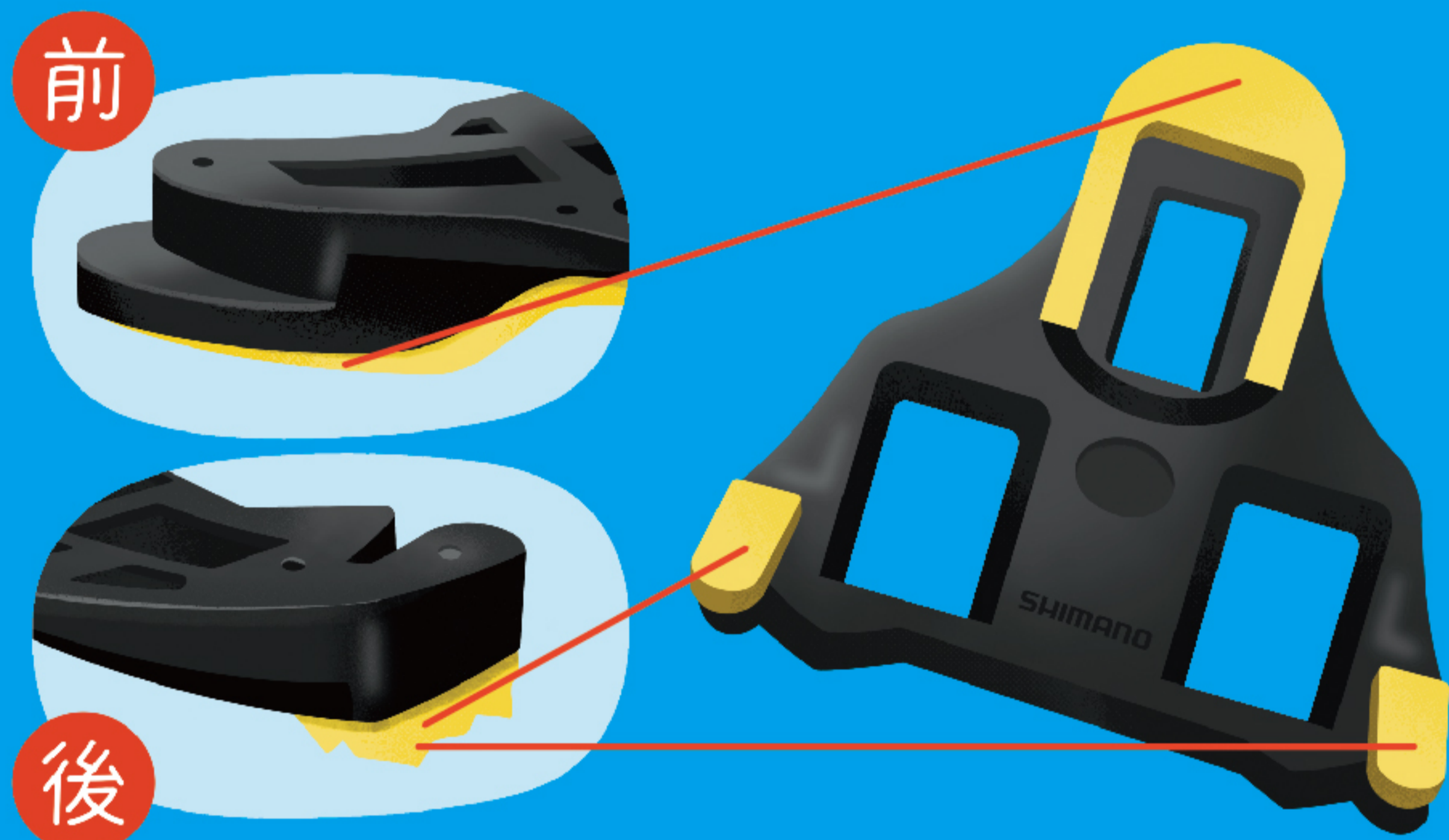
鞋底扣片變得難以脫卡、或者脫卡時所需力量變得比全新時輕鬆許多，就應該換扣片了。
