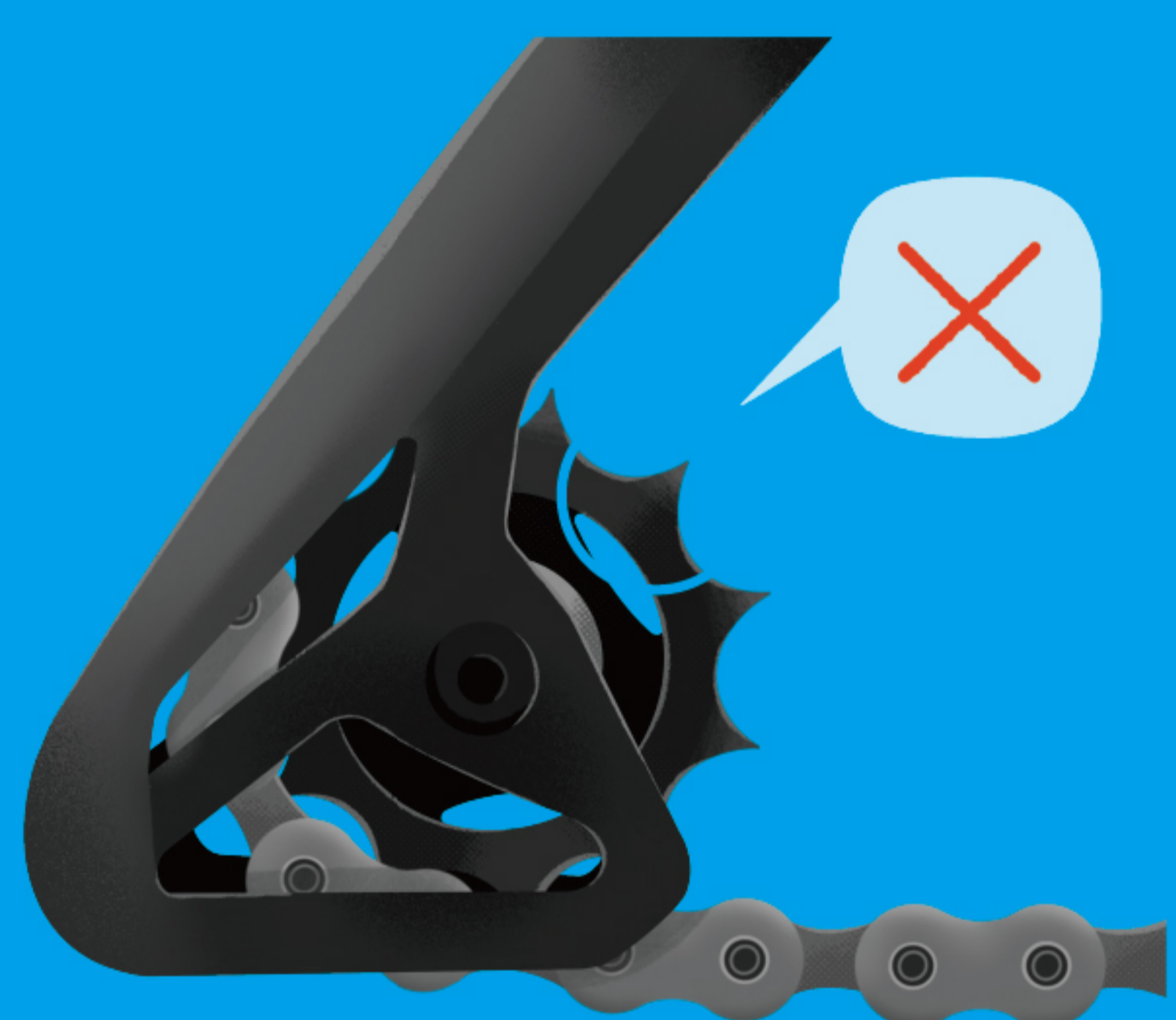
如導輪破裂、齒尖磨尖或損壞，會影響變速/傳動性能。
