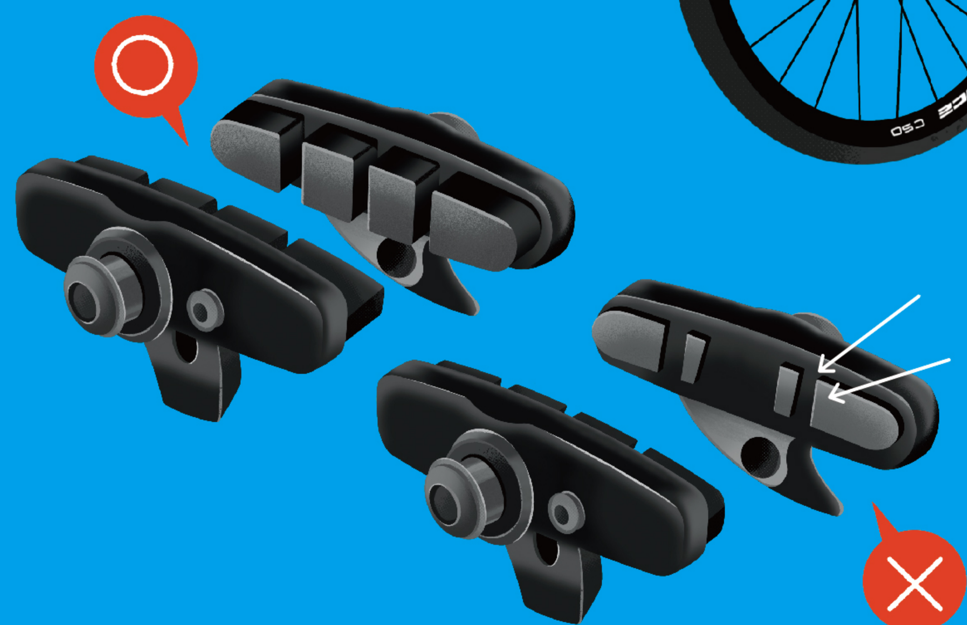
當煞車塊看不到凹槽時，就要趕緊更換了。
