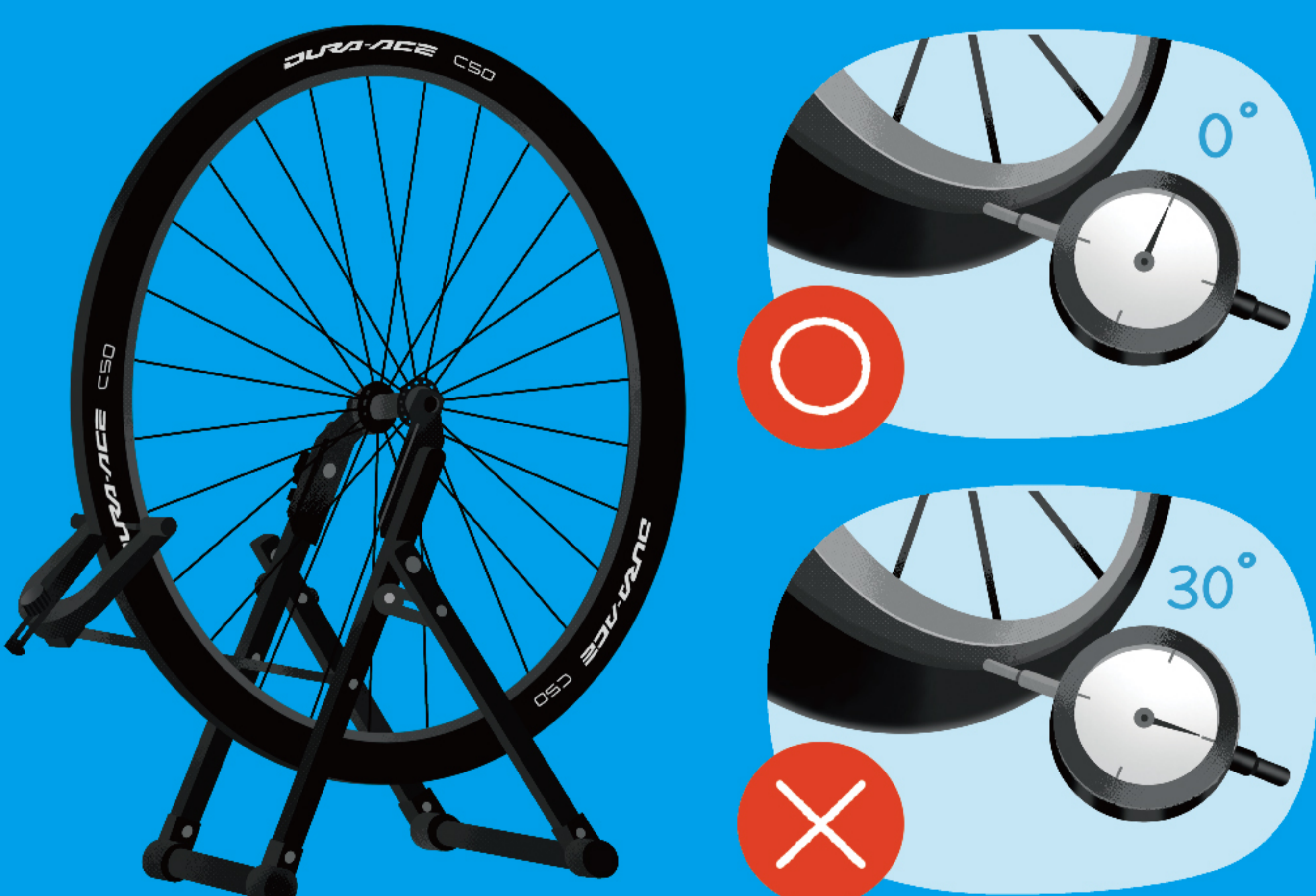
若指針有偏擺代表拉動輪框的對向輻條失去張力需要校正。逆時鐘是旋緊、順時鐘是放鬆。
