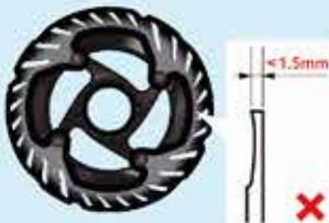
× 碟盤厚度  $< 1.5\text{mm}$
